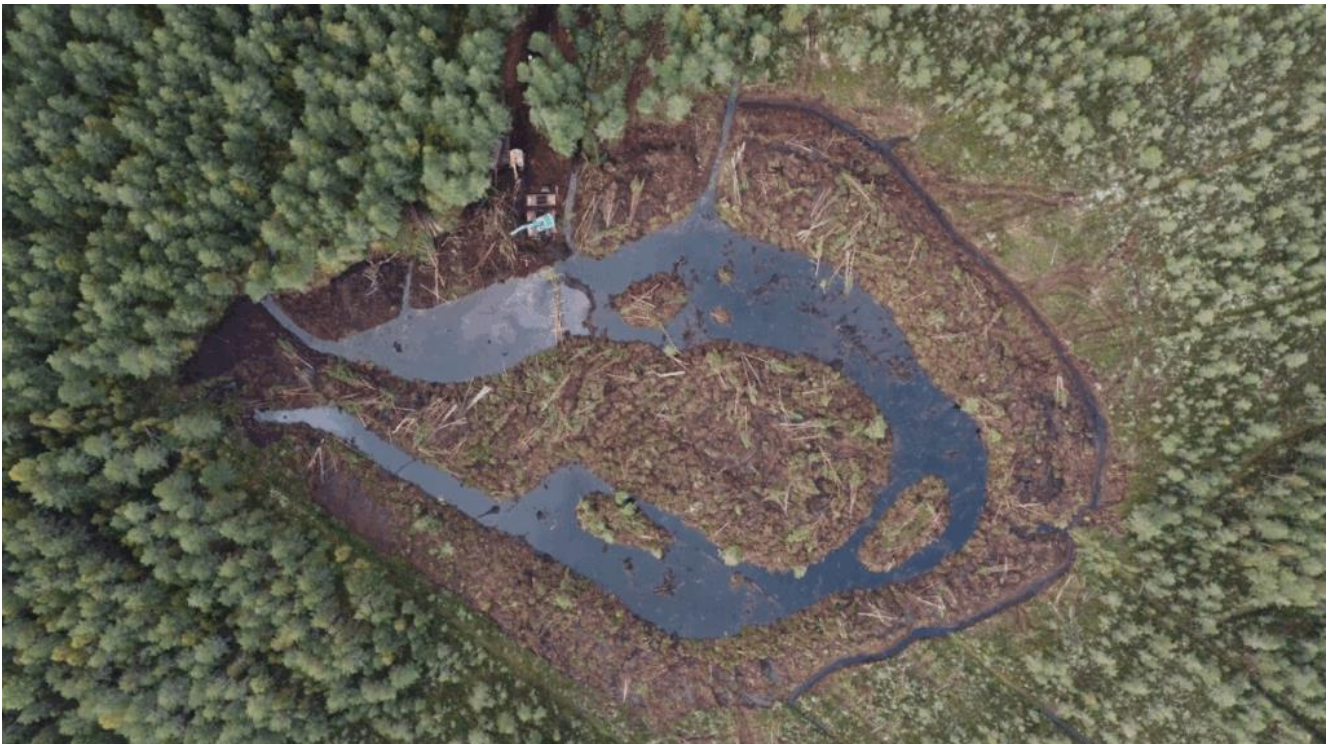
Kuva 12 Tässä kuvassa tulo-ojat näkyvät hyvin. Veden kiertosuunta on kosteikolla ylävasemmalta yläoikean kautta kiertäen myötäpäivään alas vasemmalle, josta säätöpadon kautta palautus hallitusti pääkokoomaojaan. Kosteikkoaltaan vedenpinnan tavoitekorkeus on tämän kuvan tilanteesta
